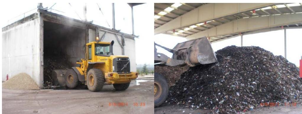
Figura IV.27. Descarga del túnel y formación de la pila de maduración.
