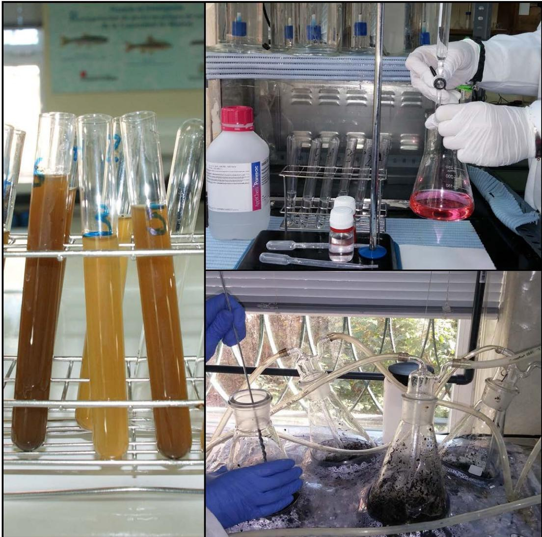
Figura 0.4. Detalles de extractos del compost para el control del pH, valoraciones, agitación periódica de cada digestor.
