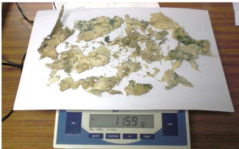
Figura IV.29. Medida de peso seco de las muestras tras el compostaje.
