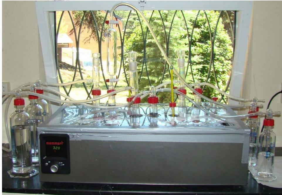
Figura 0.1. Vista frontal del sistema de lavadores de gas, digestores y baño.
