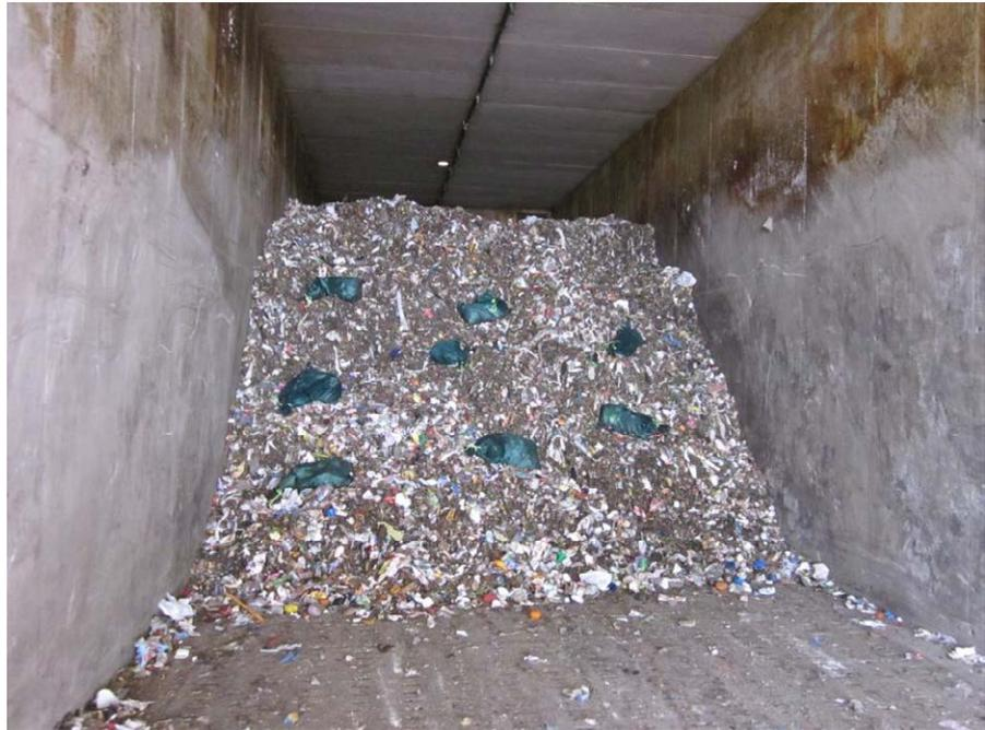
Figura 0.15. Carga del túnel de la planta de Arenas de San Pedro.
