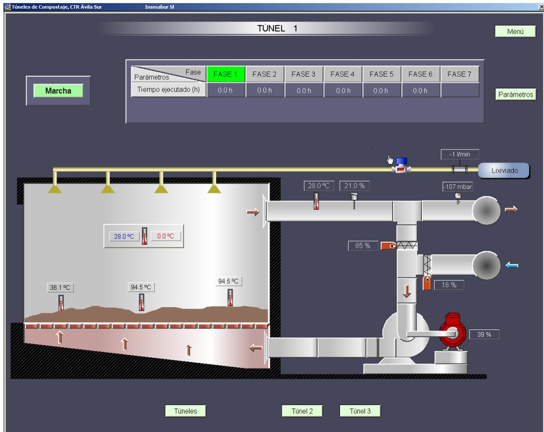
Figura IV.21. Detalle de la circulación de aire, localización de las sondas de temperatura, concentración de oxígeno y distribución del sistema de regado.
